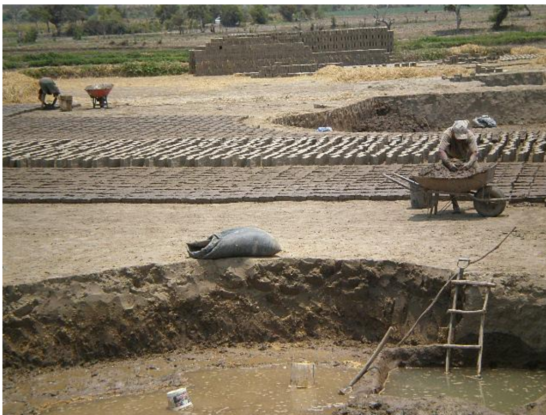
Figura 17. Adobes en proceso de elaboración y en la fase de secado, en el valle de Jequetepeque, norte de Perú (Foto: C. Gálvez)
