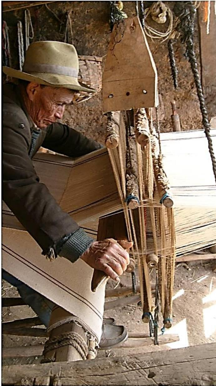
Figura 13: Procedimiento de elaboración de un tejido con el telar a pedal
