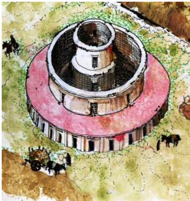
Figura 4: Dibujo del palomar de Diego Casero, construido en 1788, con su doble estructura concéntrica (Cortesía Carlos Moreno).
