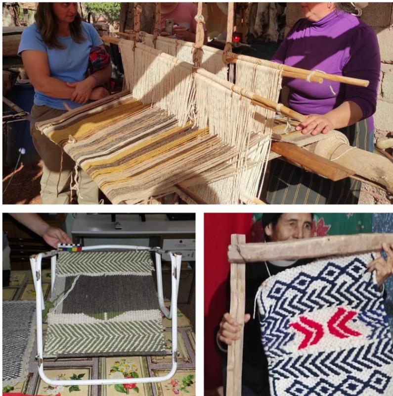
**Figura 2:** Telar criollo (arriba) y telar en bastidor (abajo).
